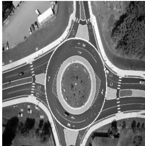
Sl. 7.21. Kružni tok sa slike 7.15. s ucrtanom detektiranom kružnicom pomoću Hough-ove transformacije
