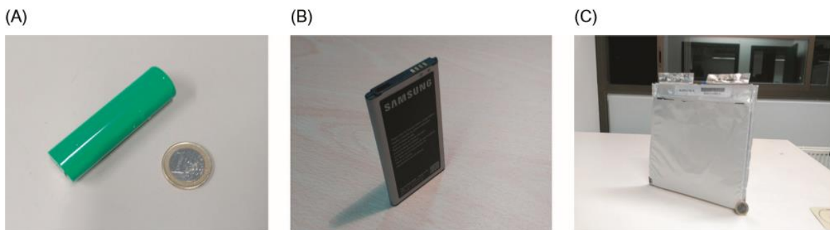
Slika 3.10 Izgled oblika Li-ion baterija: A) cilindrični, B) pljosnati, C) u obliku vrećice [11]
