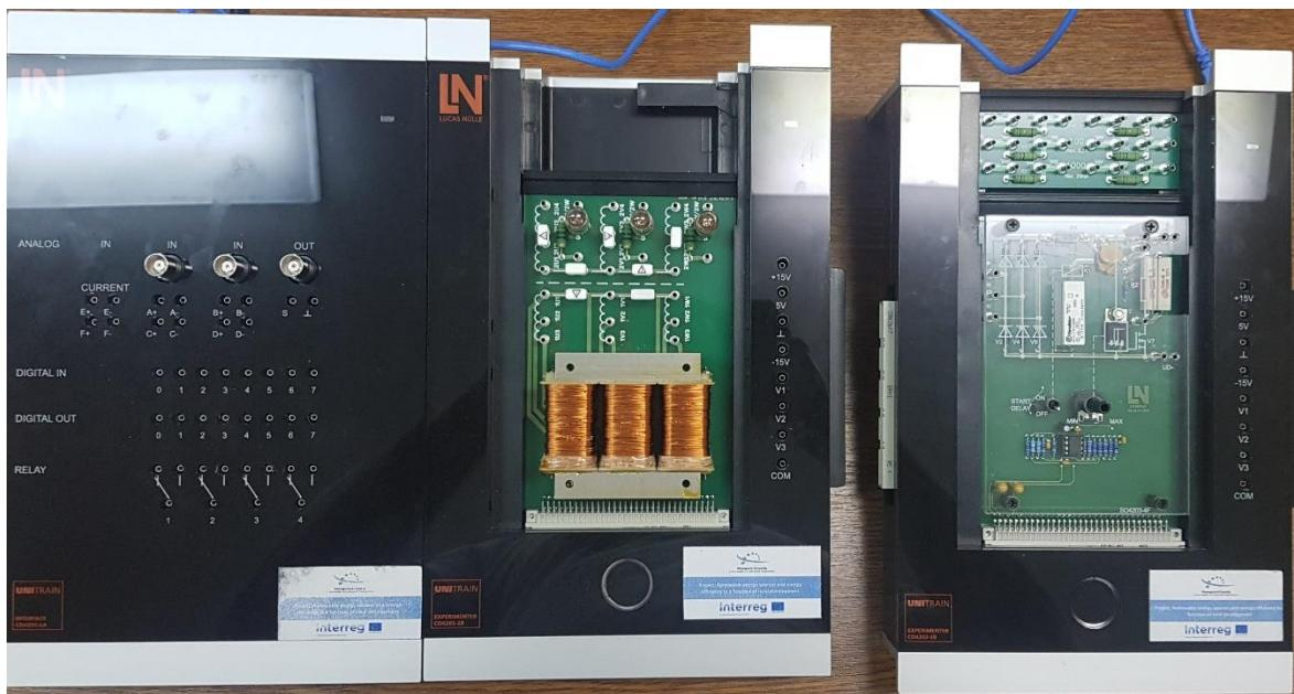
Slika 4.1 LN upravljačka ploča i eksperimentalne kartice transformatora ispravljača
