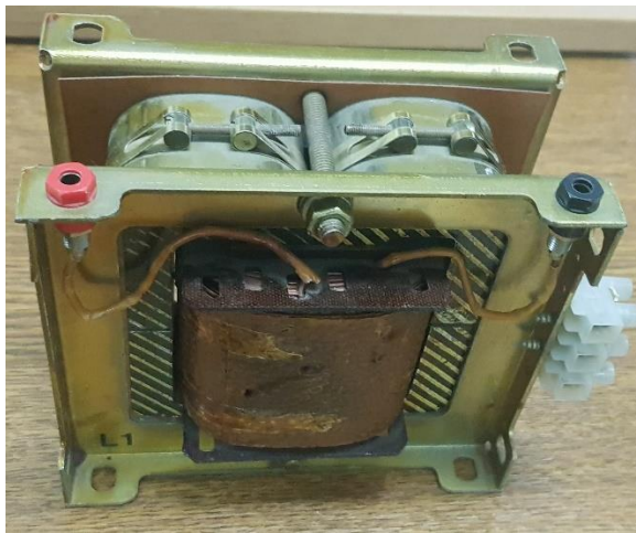
Slika 4.2 Prigušnica L=330\text{mH} ; R=2\Omega i promjenjivi otpornik 3300\Omega ; 0.3\text{A}
