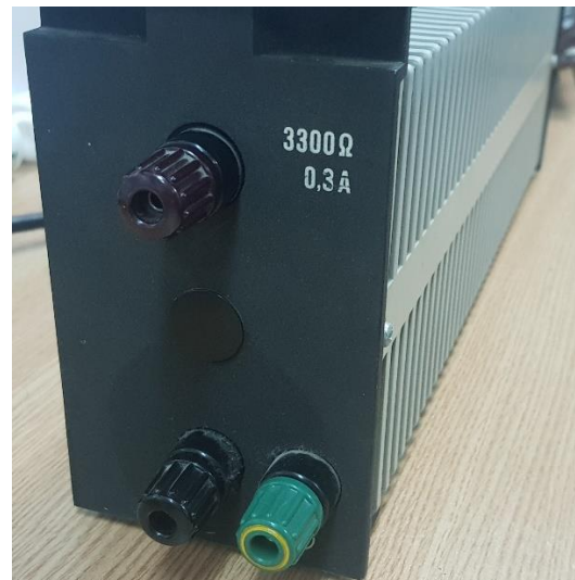
Slika 4.2 Prigušnica L=330\text{mH} ; R=2\Omega i promjenjivi otpornik 3300\Omega ; 0.3\text{A}
