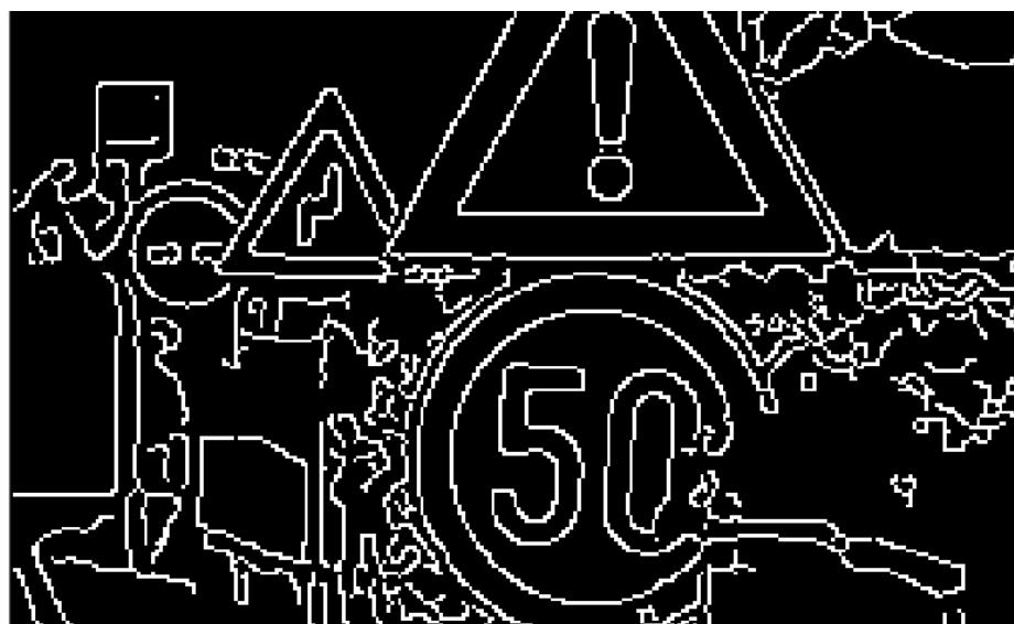
**Slika 3.5.** Monokromatska fotografija nakon korištenja Canny detektora
