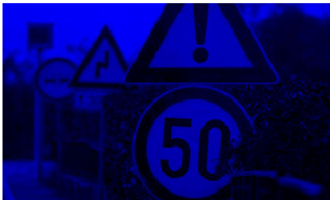
Slika 4.4. Slika koja sadrži samo B komponentu RGB prikaza
