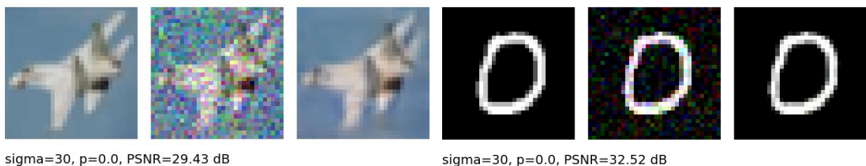
Slika 4.16: Uklanjanje šuma sa \sigma = 30 i p = 0.0
