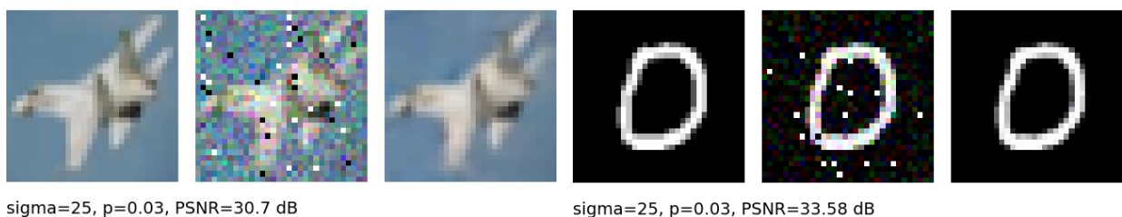
Slika 4.18: Uklanjanje šuma sa \sigma = 25 i p = 0.03
