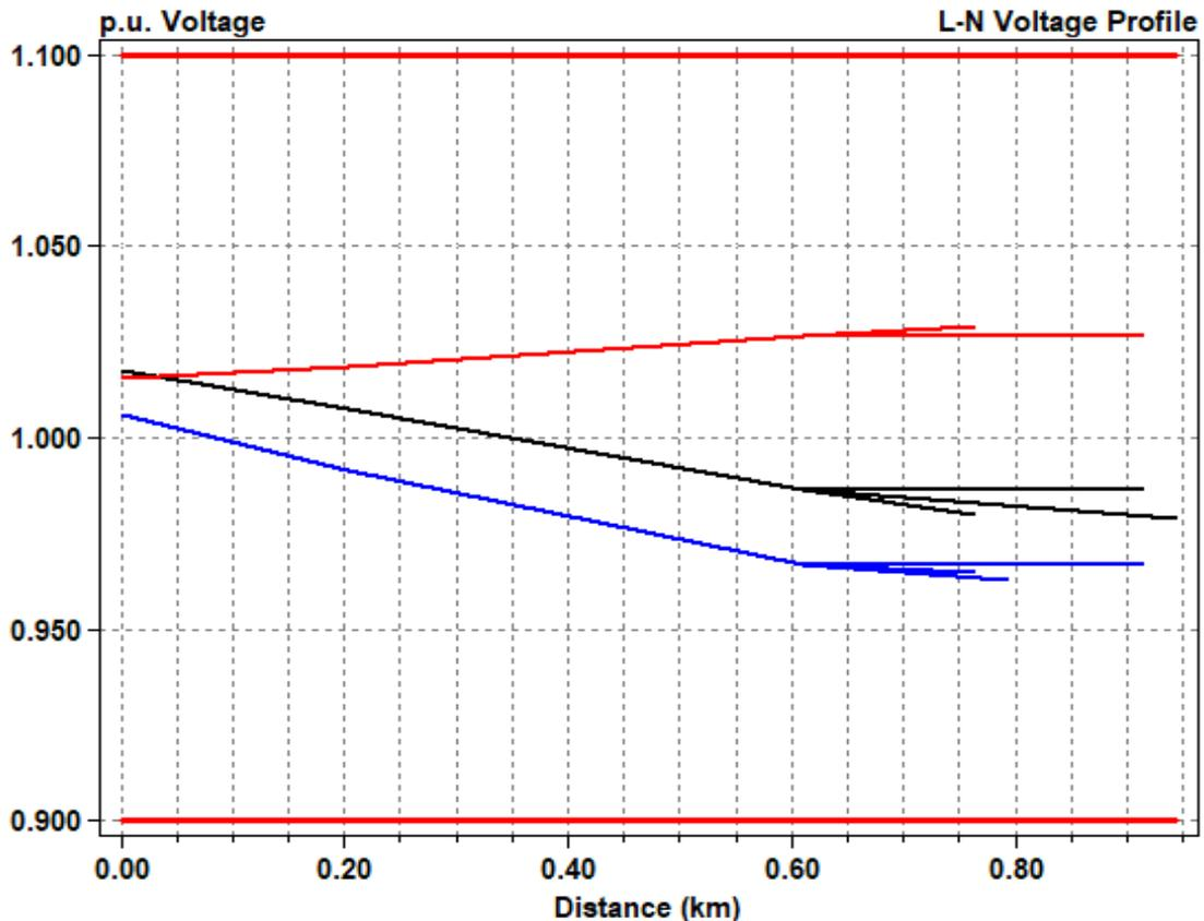
*Slika 5.13: Trofazni naponski profil mreže s distribuiranim izvorom radne i jalove snage  $P=1700 \text{ kW}/Q=85 \text{ kvar}$*
