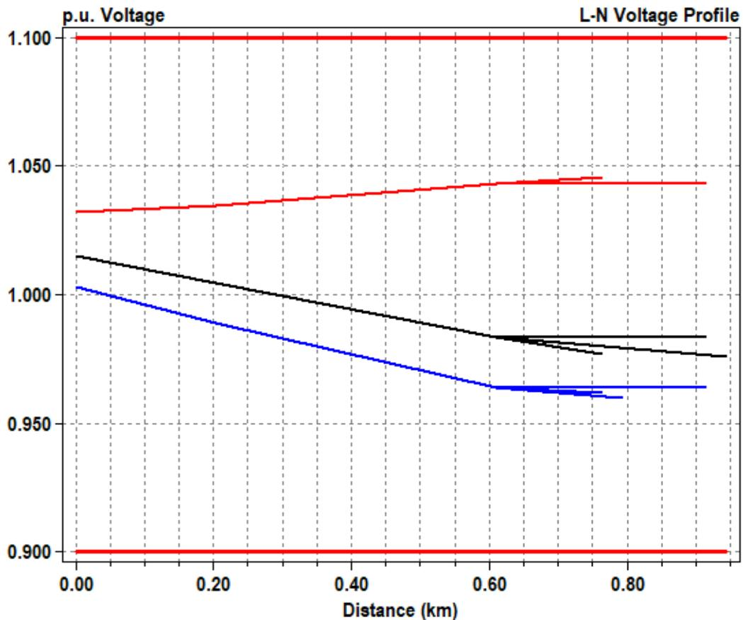
*Slika 5.9: Trofazni naponski profil mreže s distribuiranim izvorom radne i jalove snage  $P=350 \text{ kW}/Q=30 \text{ kvar}$*
