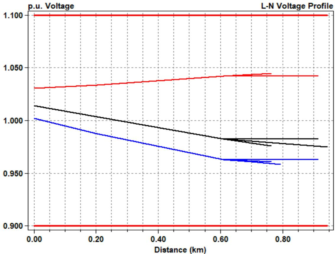
*Slika 5.4: Trofazni naponski profil mreže s distribuiranim izvorom radne i jalove snage  $P=350 \text{ kW}/Q=0 \text{ kvar}$*
