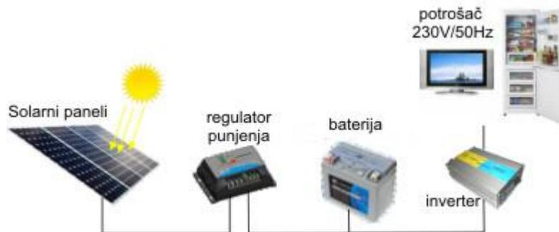
**Slika 3.4: Shematski prikaz fotonaponske elektrane [10]**
