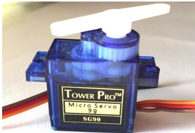
Slika 4.2.: Servo motor SG-90 [3]
