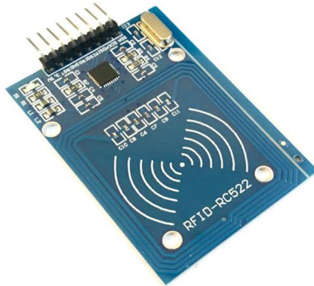
Slika 4.4: RC522 RFID čitač[5]
