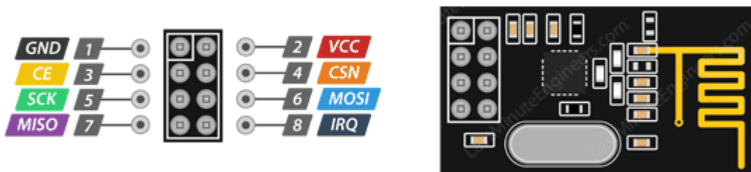
Sl. 2.1. NRF24L01 modul sa konektorima [3].
