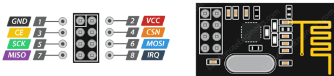
Sl. 2.1. NRF24L01 modul sa konektorima [3].
