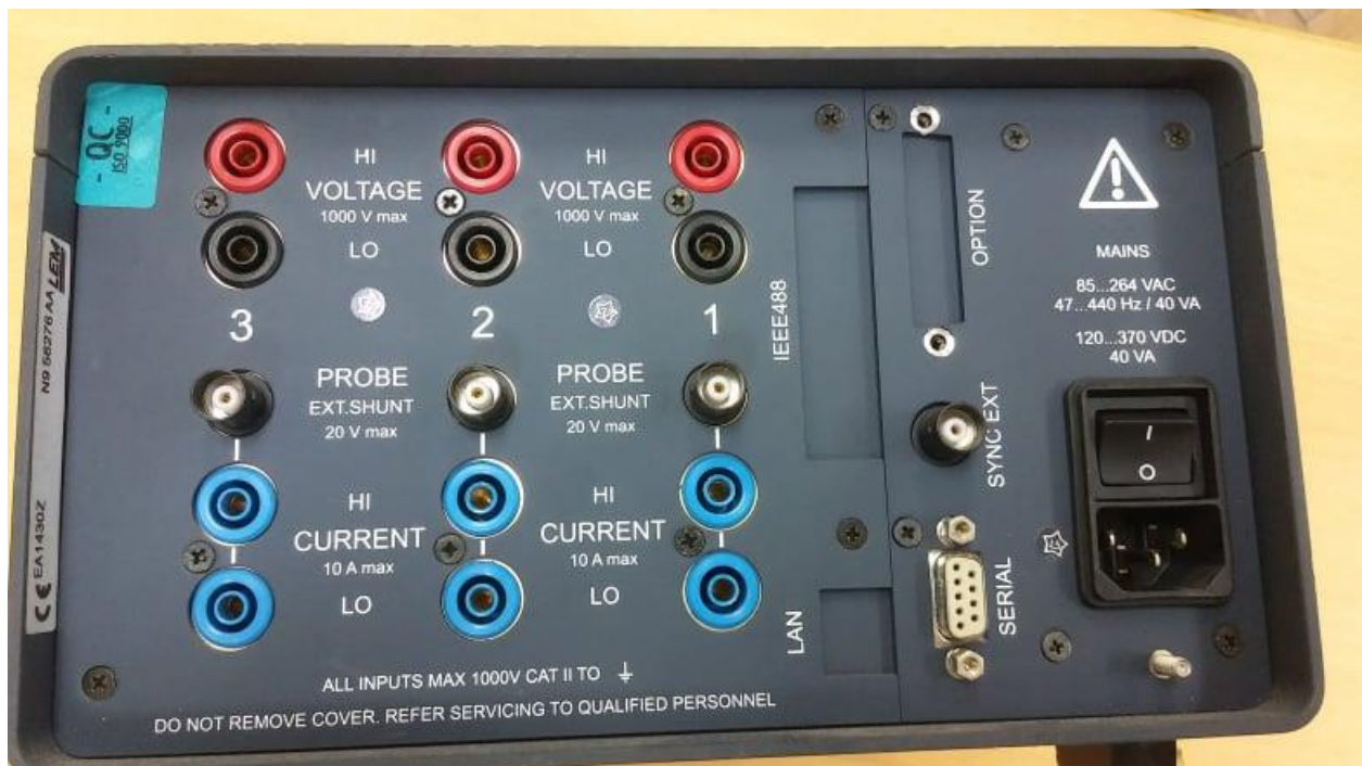
Slika 3.22. Izgled poledine analizatora snage NORMA 400.
