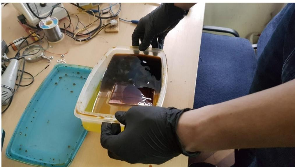
*Slika 3.3. Nagrizanje (jetkanje) tiskane pločice u kiselini.*
