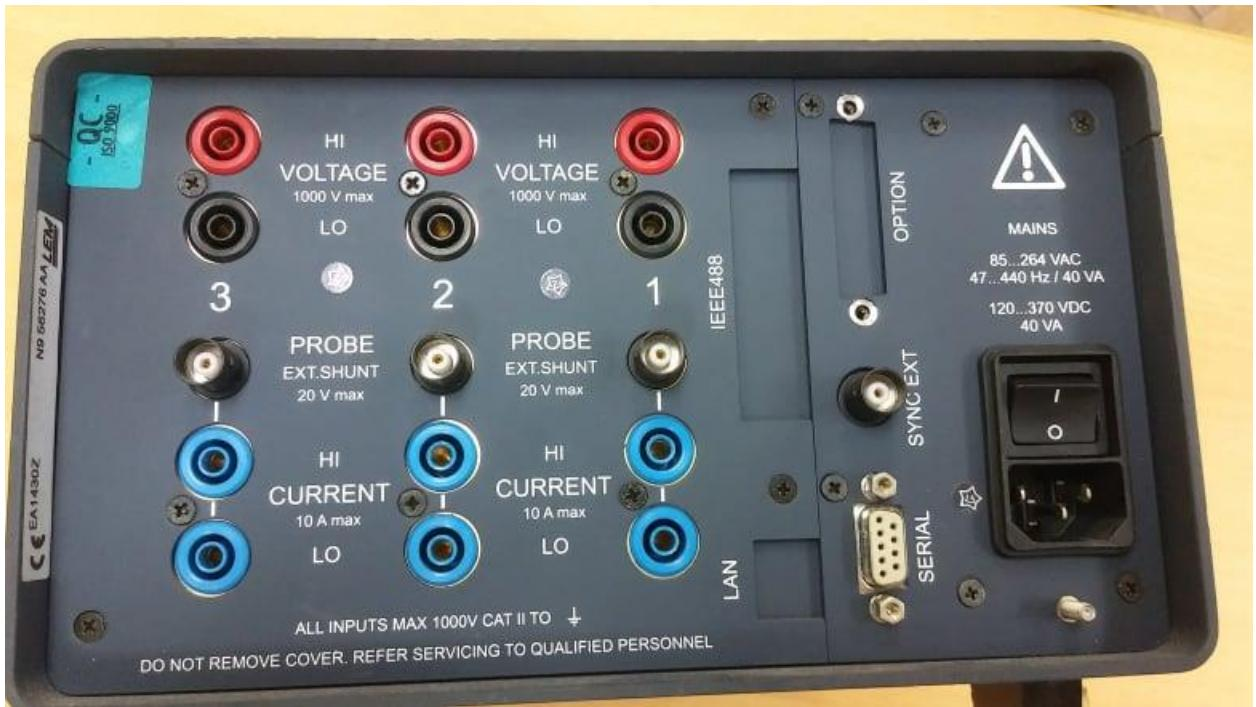
*Slika 3.22. Izgled poleđine analizatora snage NORMA 400.*
