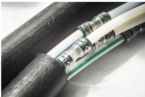
Slika 5.7: Rezultat spajanja mikrocijevi
