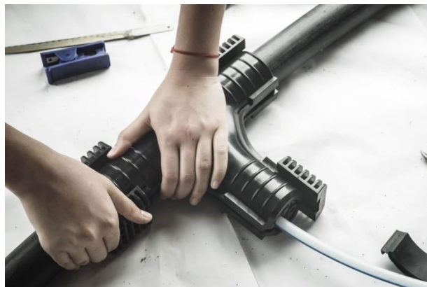
Slika 5.19: Zatvaranje T konektora
