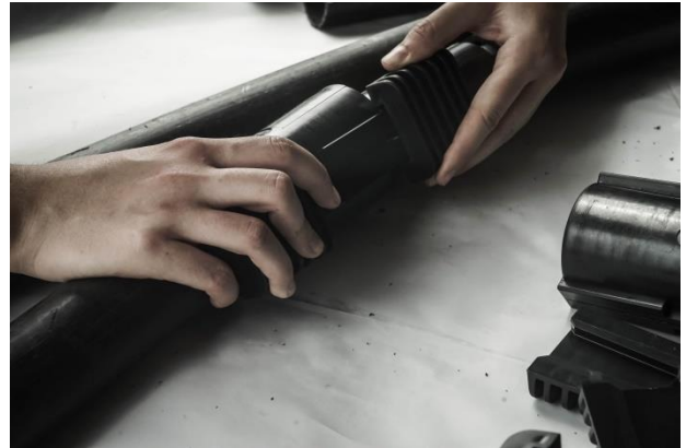
Slika 5.12: Postavljanje rebrastih brtvi na krajeve sklopivih spojnica
