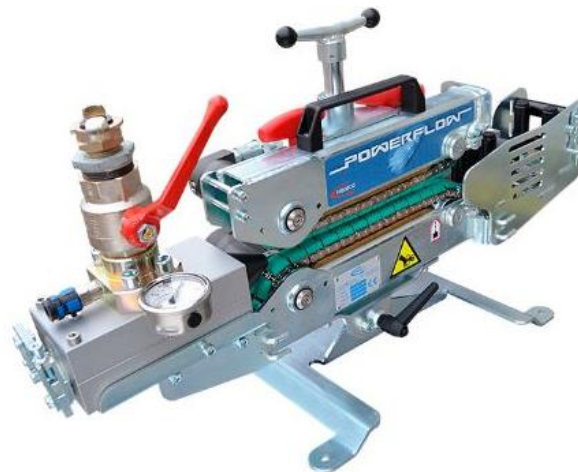
Slika 4.11: Uređaj za upuhivanje mikrocijevi, [24]
