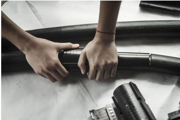
Slika 5.11: Sklapanje sklopivih spojnica
