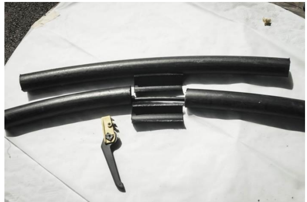
Slika 5.2: Odrezani dio cijevi putem kojeg će se uvlačiti mikrocijevi
