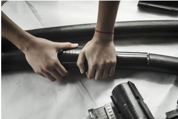
Slika 5.11: Sklapanje sklopivih spojnica
