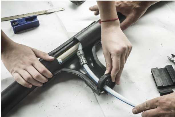
Slika 5.18: Postavljanje brtve na kraj T konektora za
