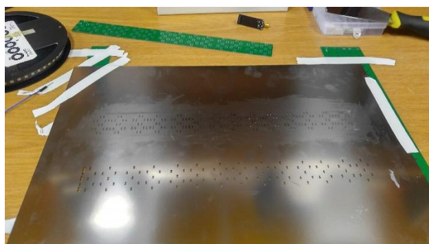
Slika 3.5 Precizno postavljanje lema
