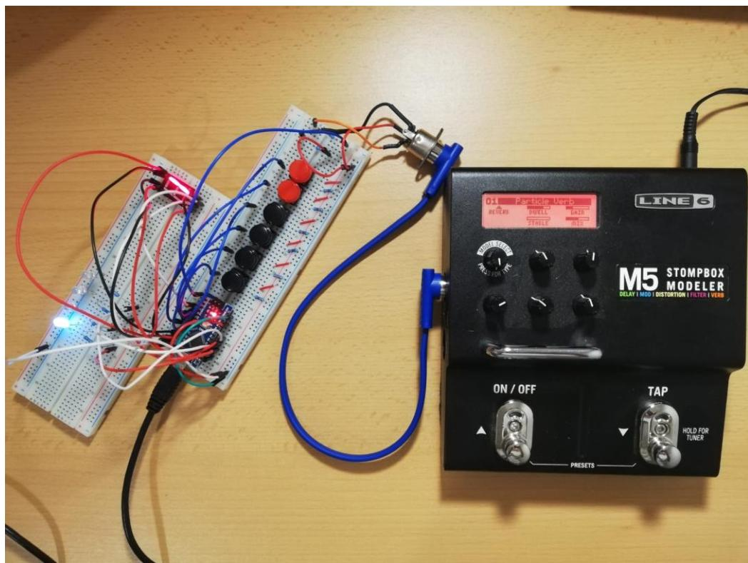
Slike 5.3. Prototip pedale za tonove električne gitare
