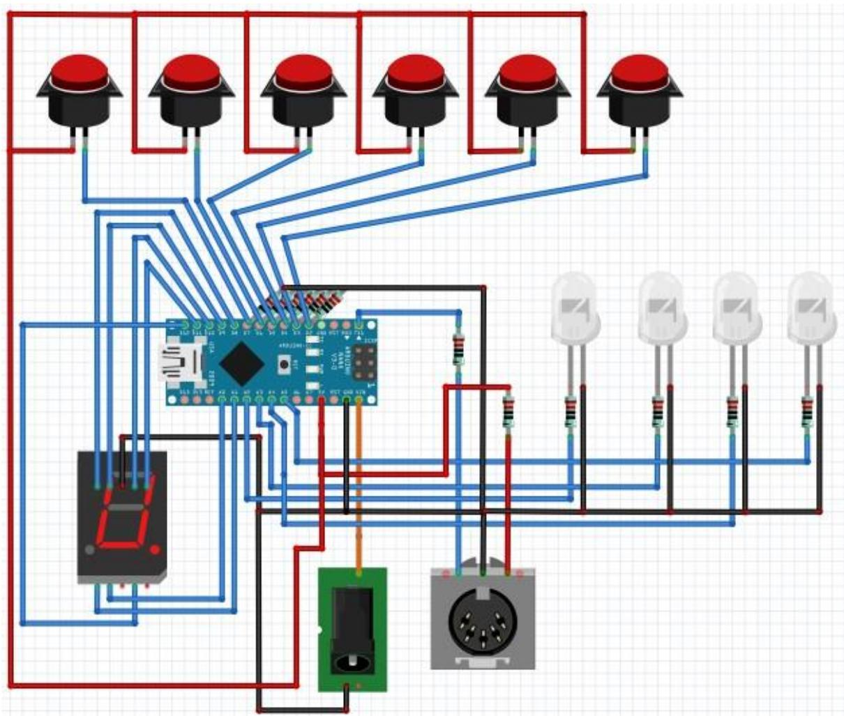
**Slika 5.1.** Shema pedale za tonove električne gitare
