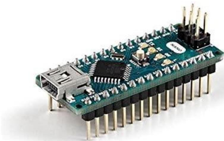
Slika 4.1. Arduino NANO pločica [13]
