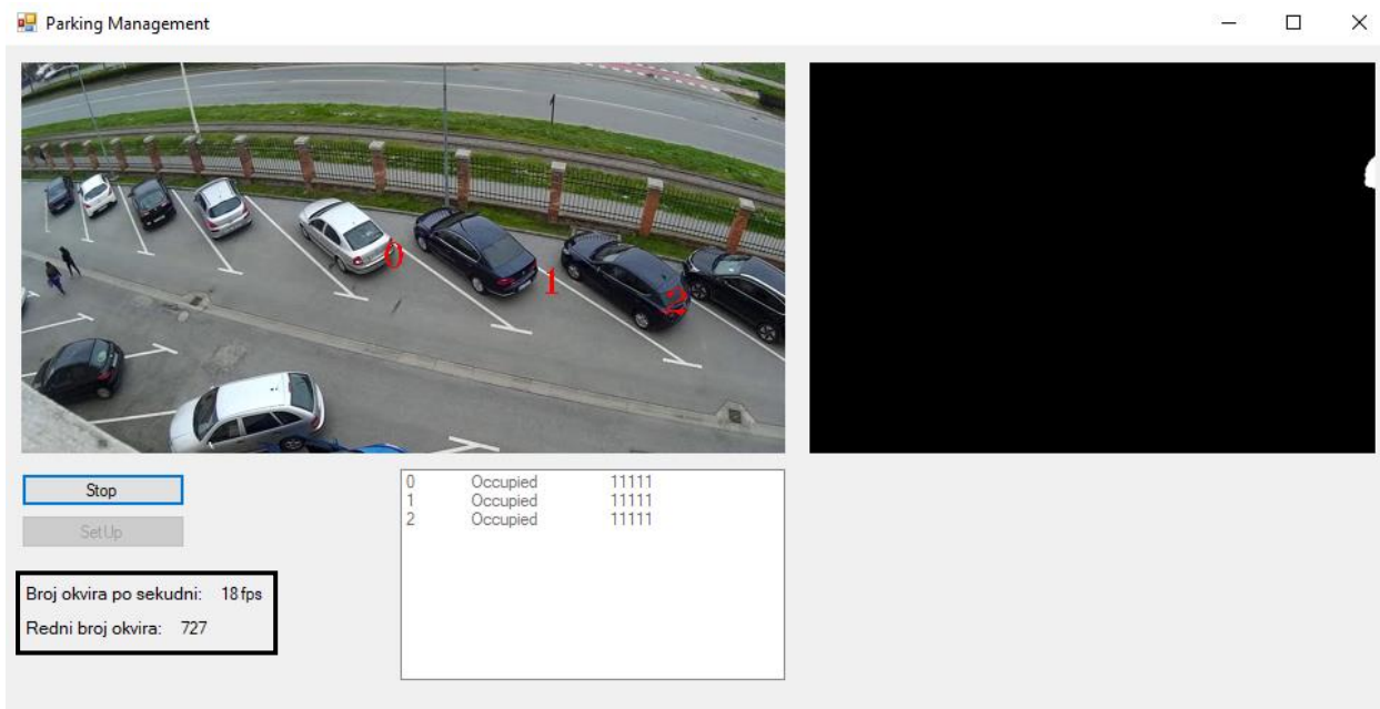
Sl. 4.13. Prikaz broja okvira po sekundi – testirano za tri parkirališna mjesta na Asus prijenosnom računalu
