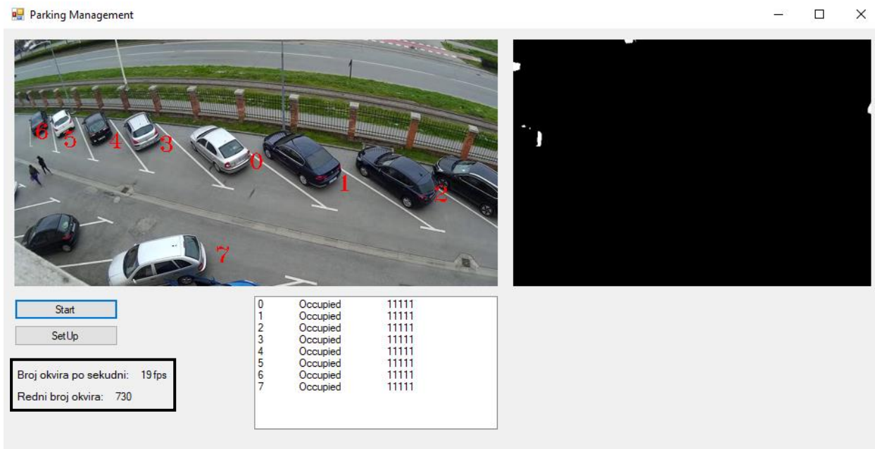
Sl. 4.15. Prikaz broja okvira po sekundi – testirano za osam parkirališnih mjesta na Asus prijenosnom računalu
