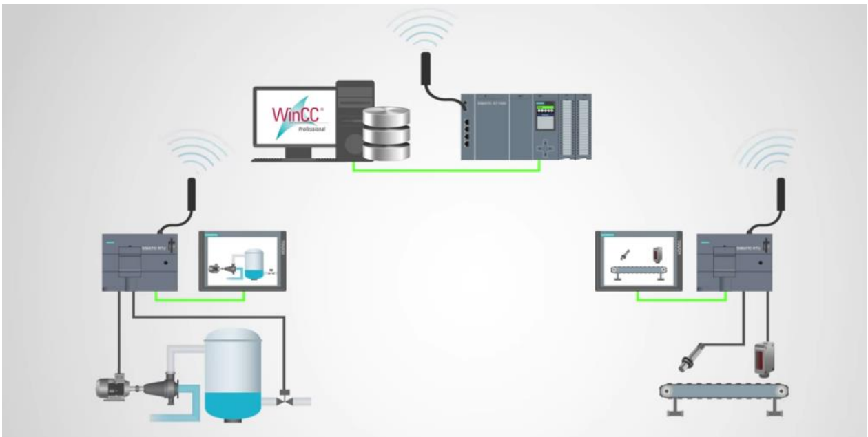
Slika 2.40. Komunikacija uređaja u SCADA sustavu [24]
