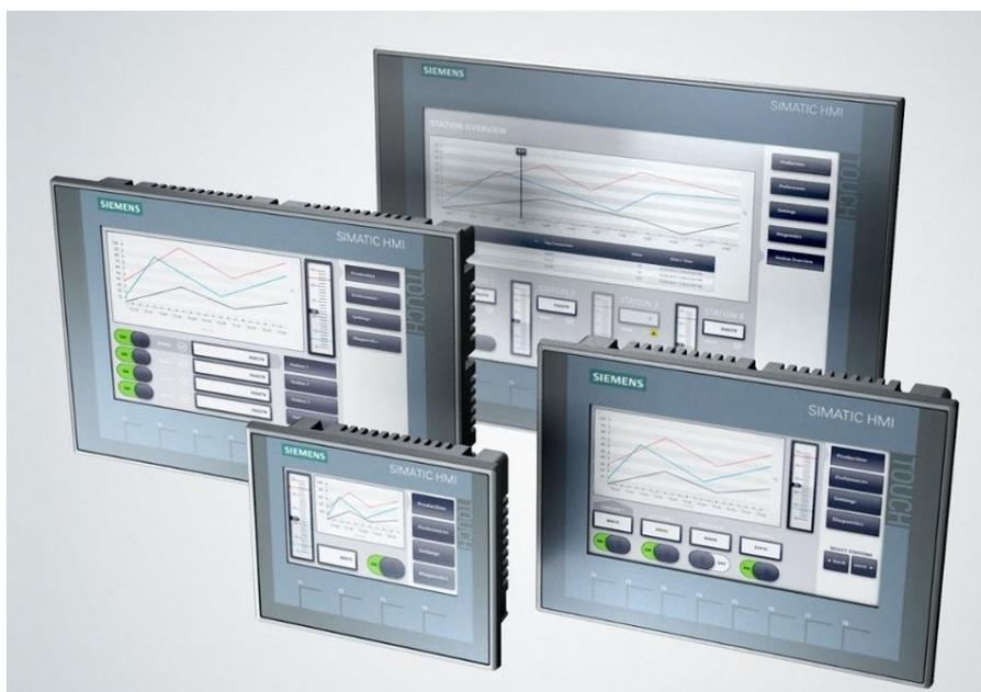
Slika 2.17. Primjer SIEMENS HMI panela [13]
