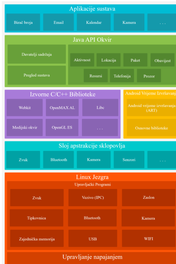
Slika 3.2. Dijagram glavnih komponenti Android platforme, izrađen prema [22]
