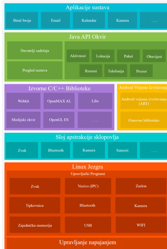
Slika 3.2. Dijagram glavnih komponenti Android platforme, izrađen prema [22]
