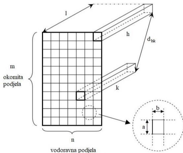
Slika 3.1. Podjela masivnog vodiča u MC modelu, [14]
