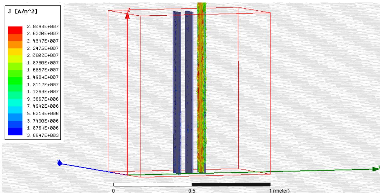
**Slika 5.18.** Gestoća struje pri kratkom spoju u fazi C u 3D modelu
