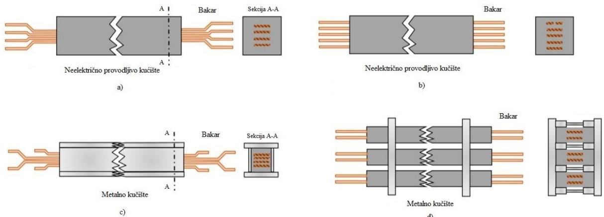
**Slika 2.2.** Primjeri prolaska sabirnica unutar metalnog kućišta, [5]
