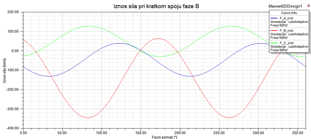
Slika 5.7. Iznos sile u sabirničkom sustavu pri kratkom spoju u fazi B u 2D modelu
