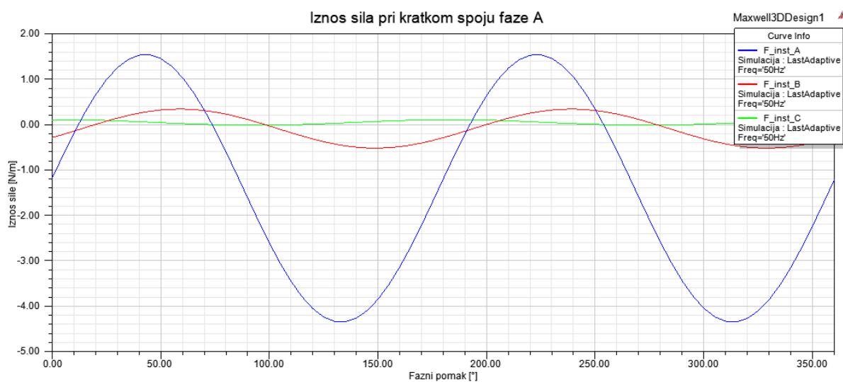
Slika 5.13. Iznos sila u sabirničkom sustavu pri kratkom spoju u fazi A u 3D modelu
