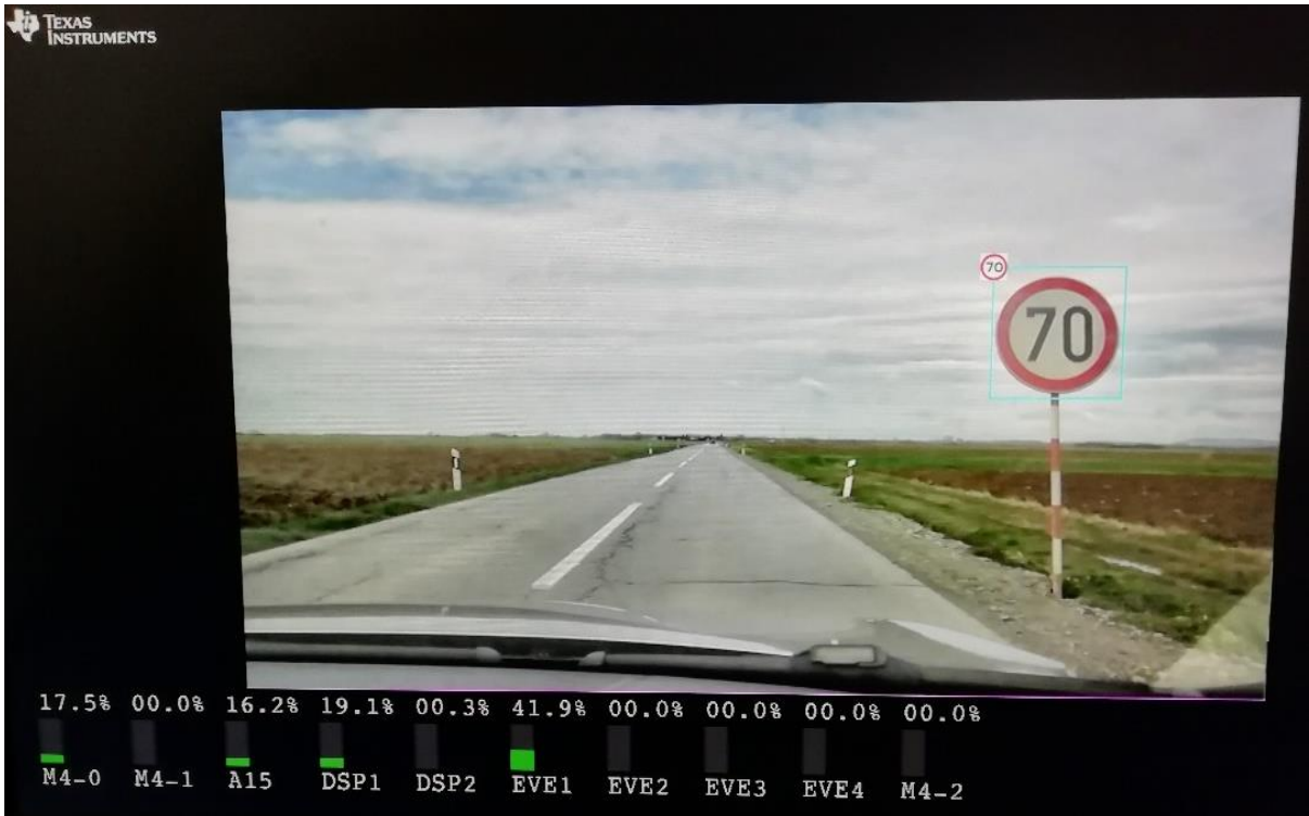
Sl. 3.5. Rezultat detekcije i klasifikacije Object detection algoritma
