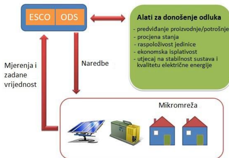
Slika 3.6. Centralizirani način upravljanja [2]
