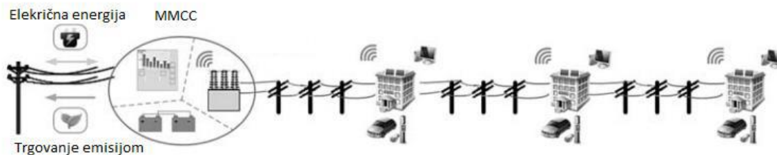
Slika 2.1. Mikromreža na razini opskrbnog voda [2]
