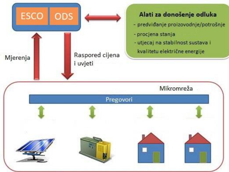
Slika 3.7. Decentralizirani način upravljanja [2]
