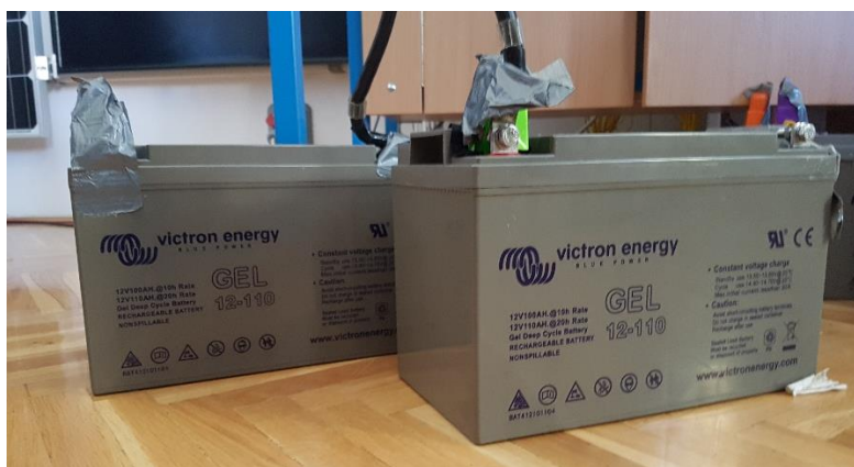
Slika 4.2. GEL baterije 12V, 110Ah
