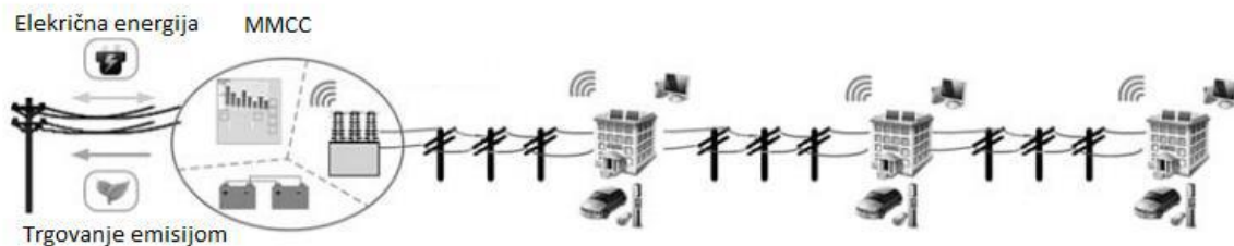
Slika 2.1. Mikromreža na razini opskrbnog voda [2]
