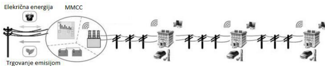
Slika 2.1. Mikromreža na razini opskrbnog voda [2]
