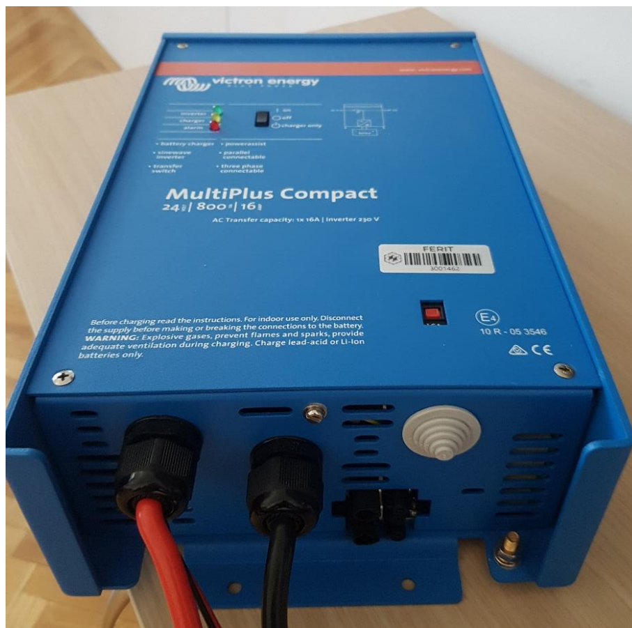
Slika 4.7. Izmjenjivač/punjač Multiplus Compact 24/800/16
