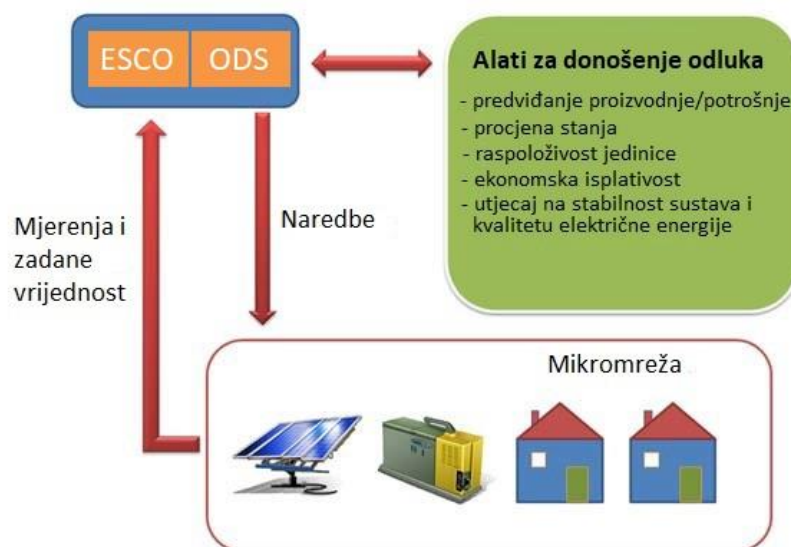
Slika 3.6. Centralizirani način upravljanja [2]
