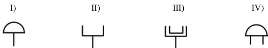
**Slika 3.14** Simboli za priključnicu optičkog kabela (I), utičnicu priključnice RJ45 (II), antensku utičnicu (III) te električno zvono (IV)
