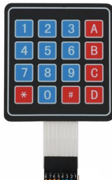
Slika 4.4. Tipkovnica Keypad 4x4
