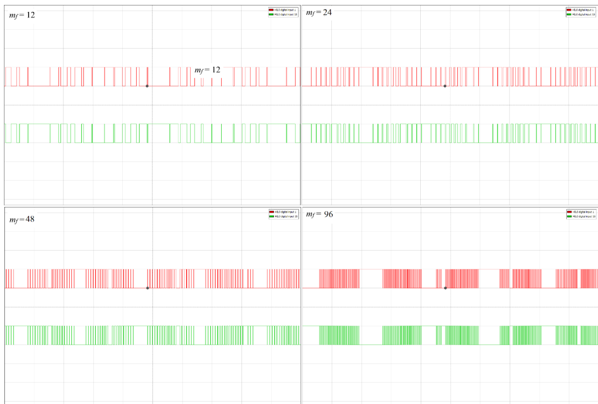
Slika 5.19. Usporedba upravljačkih signala pri različitim m_f , m_a = 1.0 .
