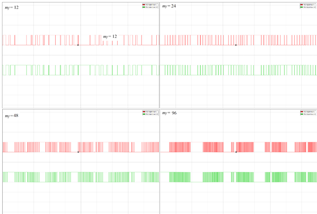
Slika 5.19. Usporedba upravljačkih signala pri različitim m_f , m_a = 1.0 .
