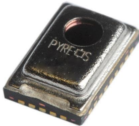
Slika 3.4. ezPyro CO2 senzora[21]
