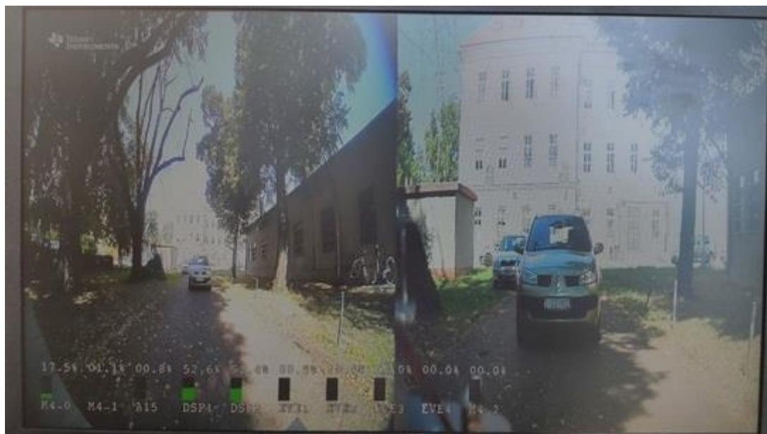
Sl. 4.2. Prikaz izlaznog signala na ekranu za korisnički slučaj s dvije kamere – zadnja i desna kamera
