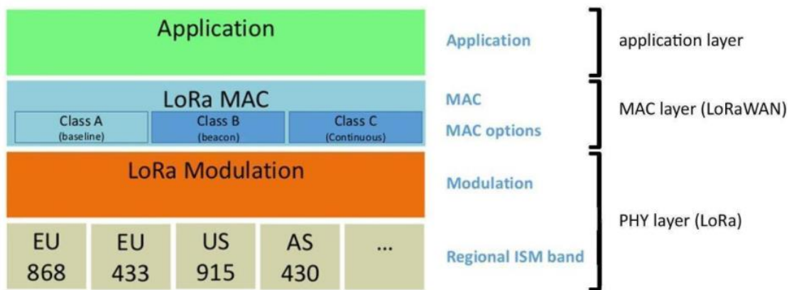
Slika 2.6. Stog LoRaWAN protokola [8]
