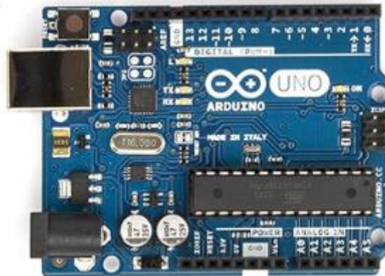
Sl. 3.1. Arduino Uno R3 mikroupravljačka pločica 6
