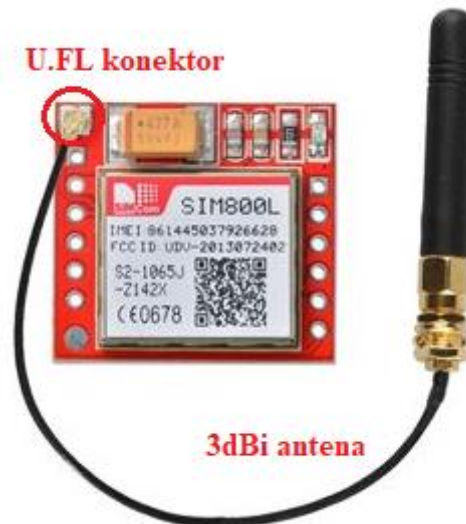
Sl. 3.7. SIM800L modul sa spojenom 3dBi antenom 10
