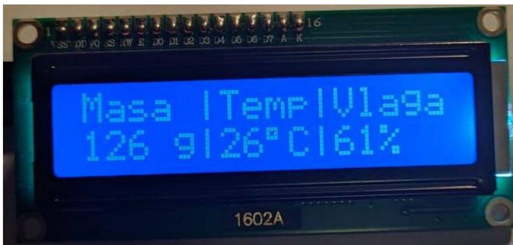
Sl. 5.1. Ispis mjerenih vrijednosti na LCD zaslon
