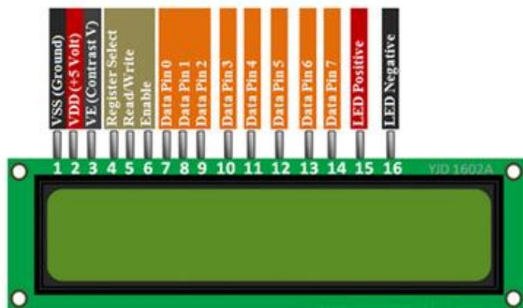
Sl. 3.16. Raspored pinova na LCD ekranu<sup>19</sup>
