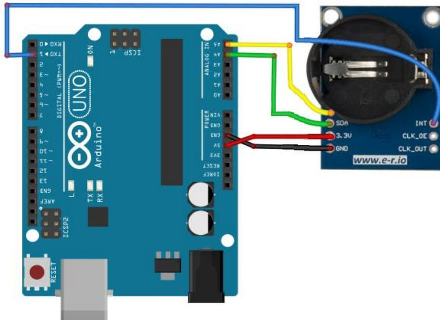
Sl. 4.6. Spajanje PCF85063A RTC-a s Arduino pločicom
