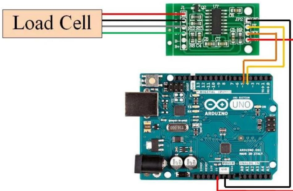
Sl. 4.4. Spajanje senzora mase i HX711 pretvarača sa Arduino UNO pločicom<sup>29</sup>
