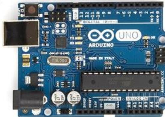
**Sl. 3.1.** Arduino Uno R3 mikroupravljačka pločica<sup>6</sup>
