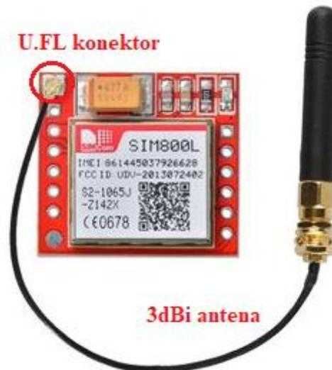
Sl. 3.7. SIM800L modul sa spojenom 3dBi antenom<sup>10</sup>
