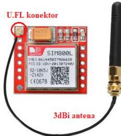
Sl. 3.7. SIM800L modul sa spojenom 3dBi antenom 10
