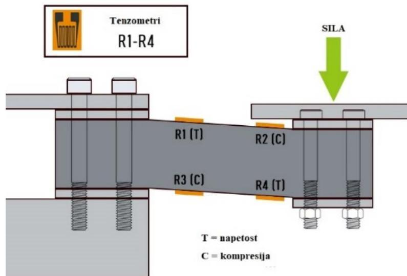
Sl. 3.13. Vizualizacija promjene otpora primjenom vanjske sile<sup>16</sup>
