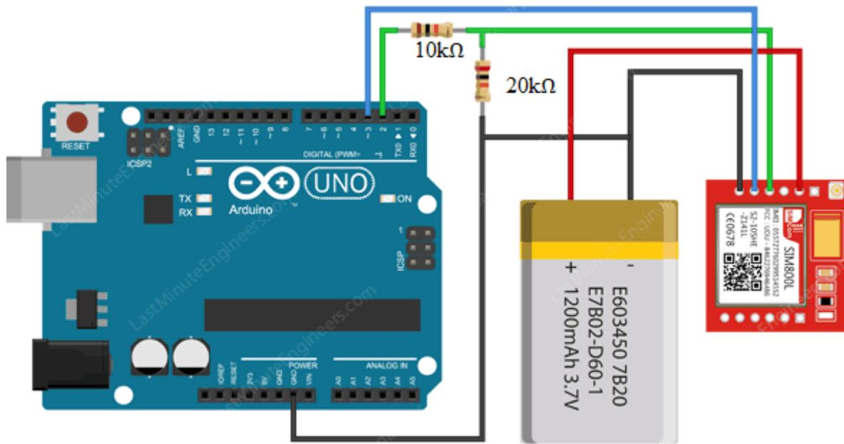
Sl. 4.7. Spajanje SIM800L modula sa Arduino UNO pločicom<sup>31</sup>
