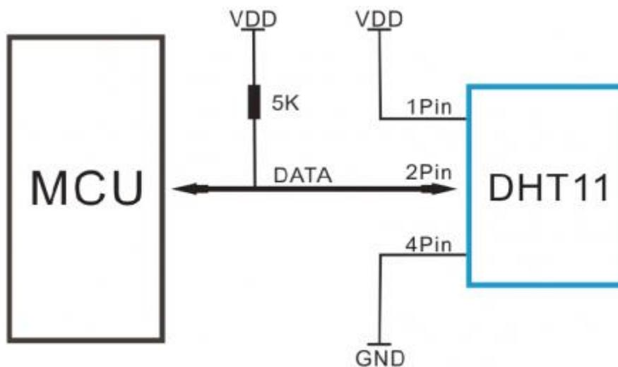
Sl. 4.5. Spajanje DHT11 senzora sa mikroupravljačem<sup>30</sup>
