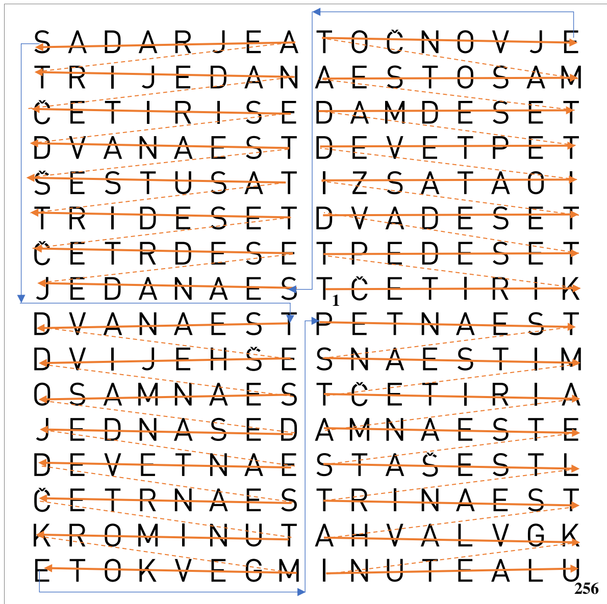
Slika 3.14: Raspored brojeva svjetlećih dioda na ploči.
