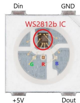
Slika 3.4: WS2812b LE dioda [4]
