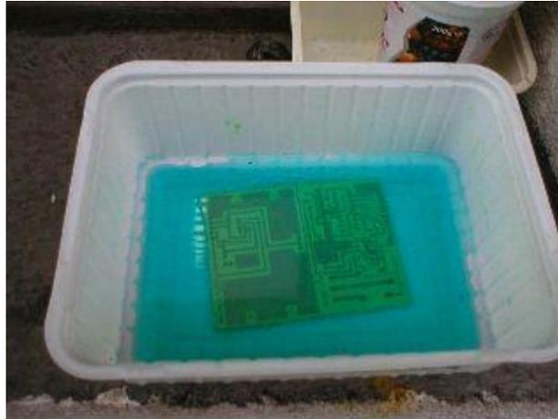
Slika 3.20: Jetkanje pločice
