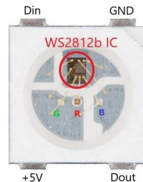
Slika 3.4: WS2812b LE dioda [4]
