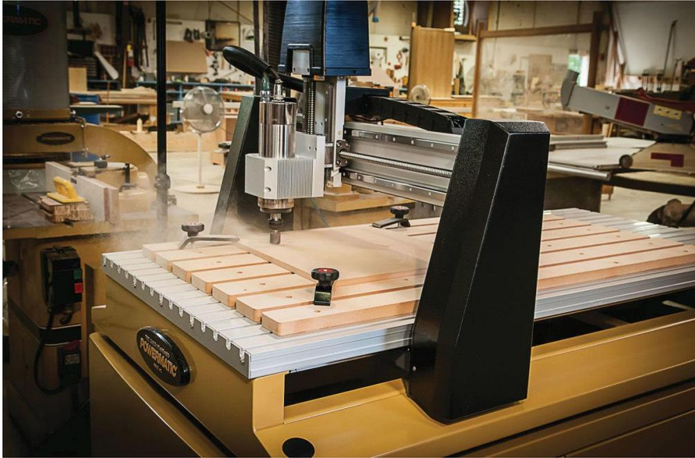
Slika 3.16: CNC obrada drveta [11]
