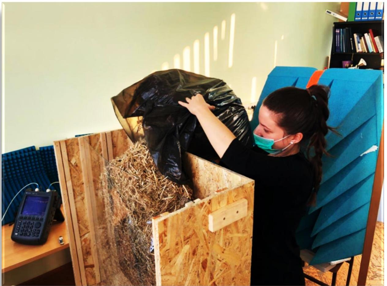
**Slika 4.16.** *Unošenje biomaterijala u pregradu kućišta*
