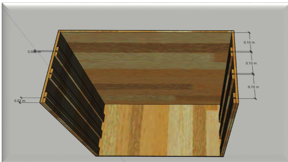
Slika 4.7. Izgled kućišta s dimenzijama
