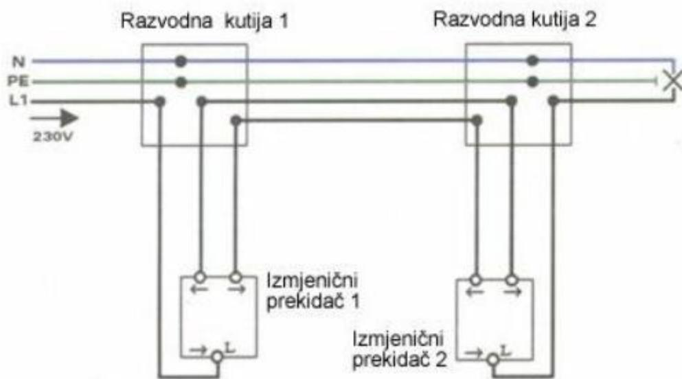
Slika 4.1.2.2. Upravljanje rasvjetom pomoću izmjeničnog prekidača, [5].
