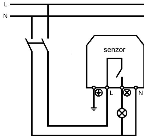
Slika 4.1.2.1 Upravljanje rasvjetom pomoću senzora pokreta, [4].
