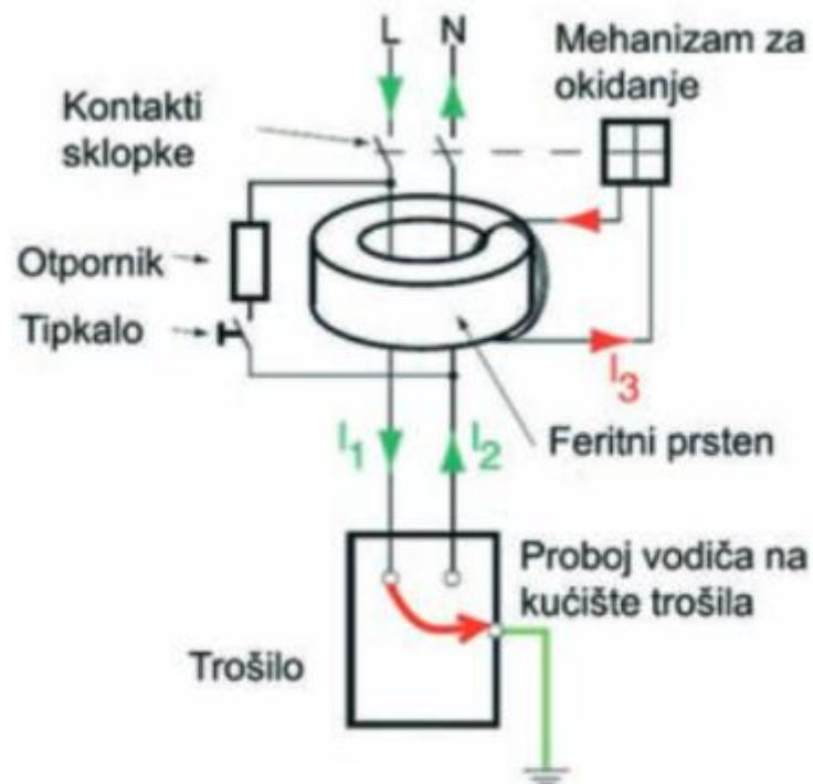
Slika 6.3.1. Princip rada RCD sklopke, [7].
