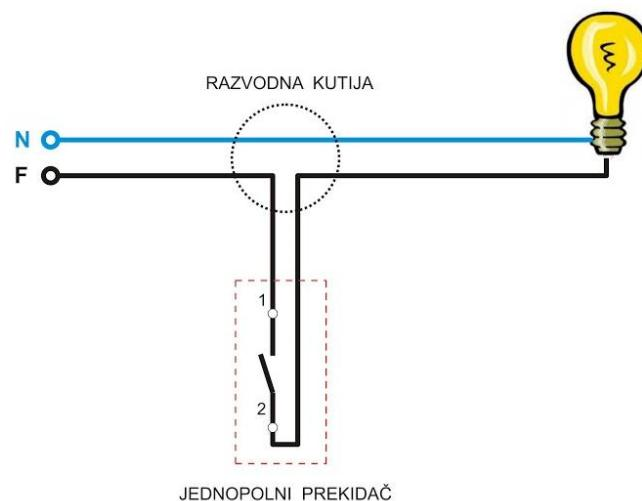
Slika 4.1.3.1. Upravljanje rasvjetom pomoću jednopolnog prekidača, [6].
