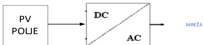
Slika 3.8. FN sustav s centralnim izmjenjivačem[13]
