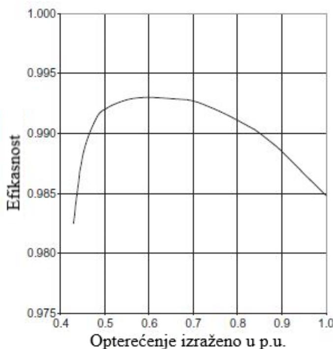
**Slika 3.2. Karakteristika ovisnosti efikasnosti o opterećenju [5]**
