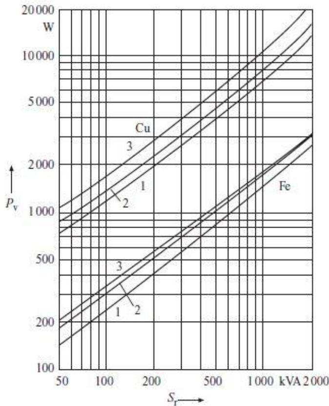
**Slika 3.3.** Gubici transformatora u bakru i željezu [7]
