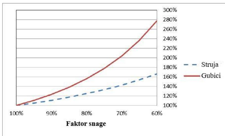
Slika 4.1. Ovisnost struje i gubitaka o faktoru snage [10]
