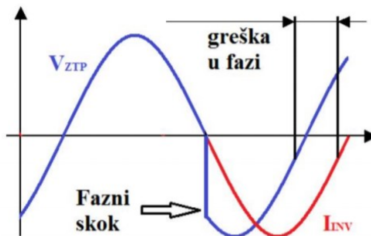
Slika 5.4. Prikaz faznog skoka u točki priključenja u slučaju otočnog rada [6]
