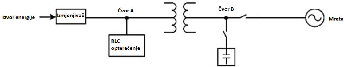
Slika 4.2. Shematski prikaz metode umetanja impedancije (kndenzatorske baterije) [1]
