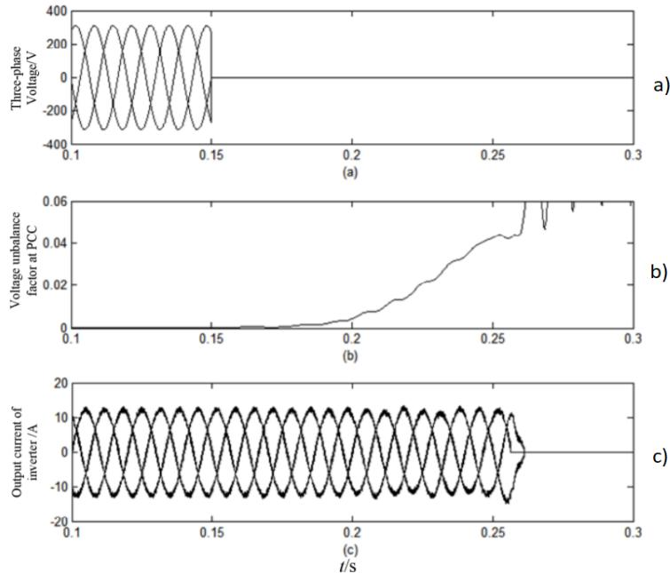
Slika 6.3. Simulacija valnih oblika kod detekcije otočnog pogona [8]
