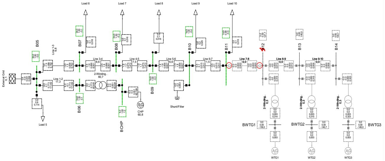
Slika 7.9. Model sustava pri 3-f kratkom spoju
