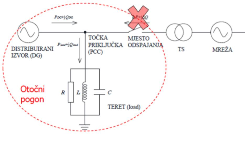
Slika 3.1. Prikaz otočnog pogona [2]
