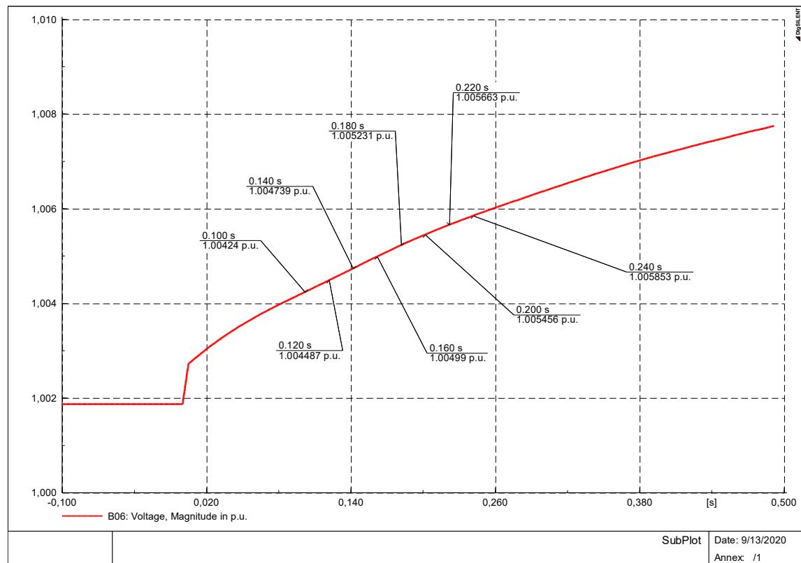
Slika 7.4. Prikaz valnog oblika napona na sabirnici B06 kod otočnog pogona nakon prorade RPS metode
