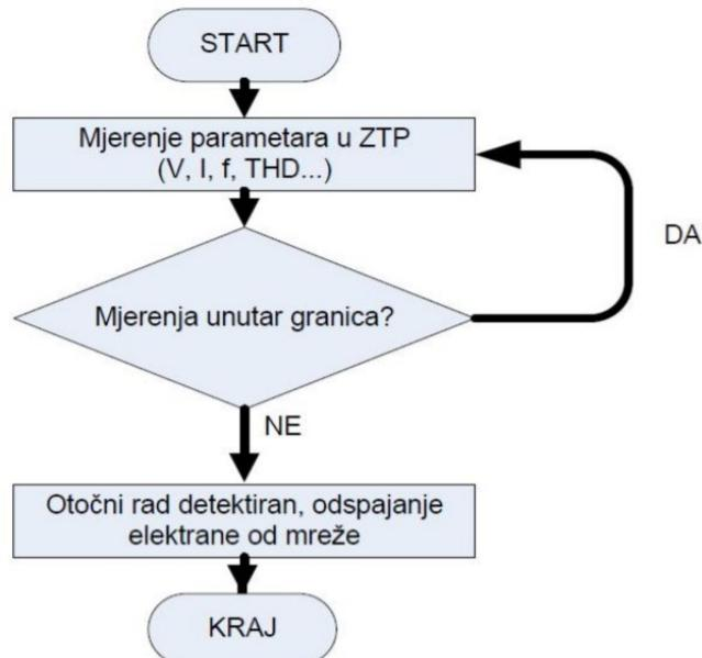
Slika 5.1. Dijagram toka rada pasivnih metoda detekcije [6]
