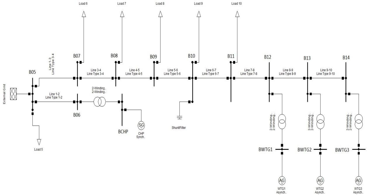
Slika 7.1. Model simuliranog sustava
