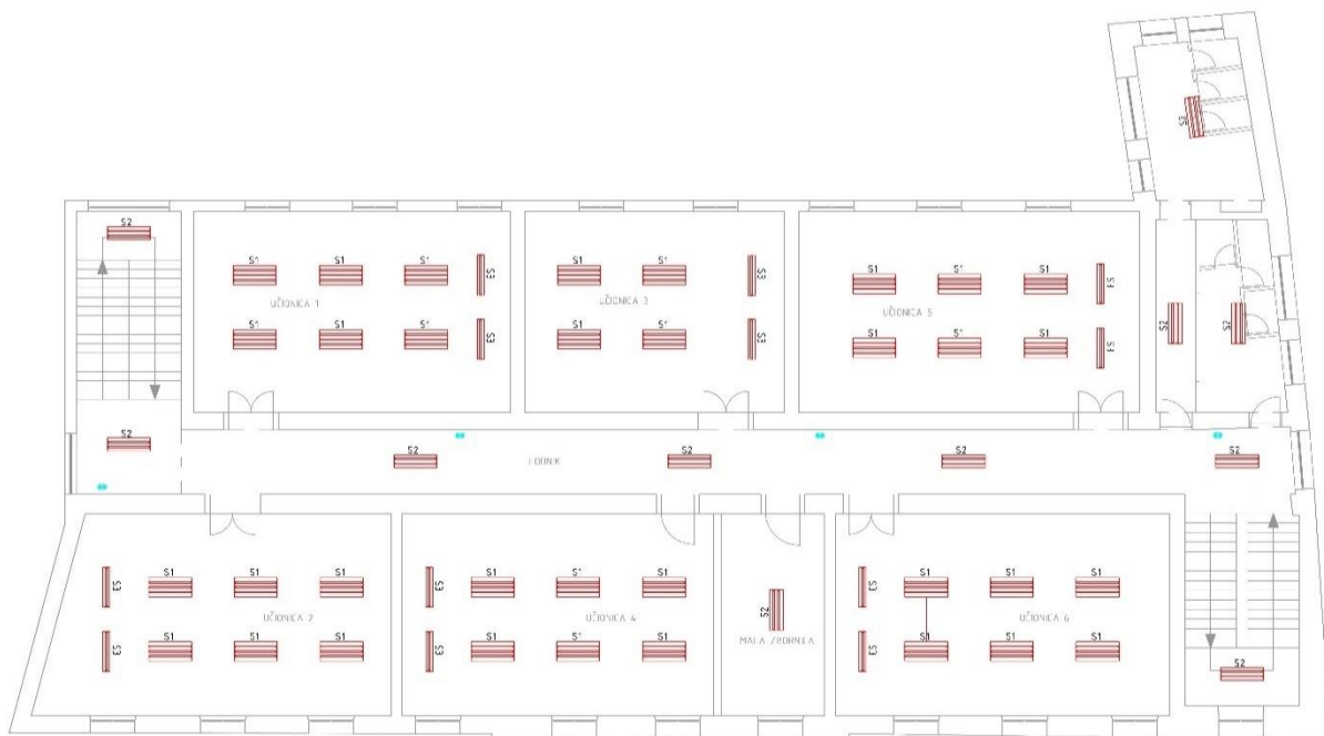
Slika 3.6. Tlocrt drugog kata – zatečeno stanje rasvjete
