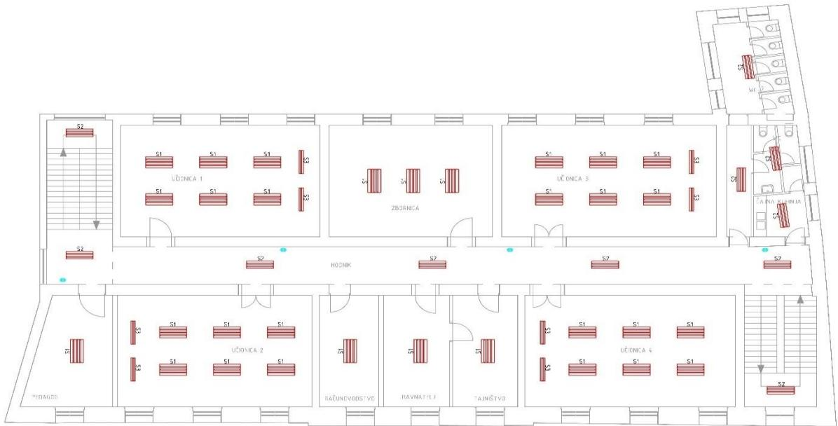
**Slika 3.5. Tlocrt prvog kata – zatečeno stanje rasvjete**
