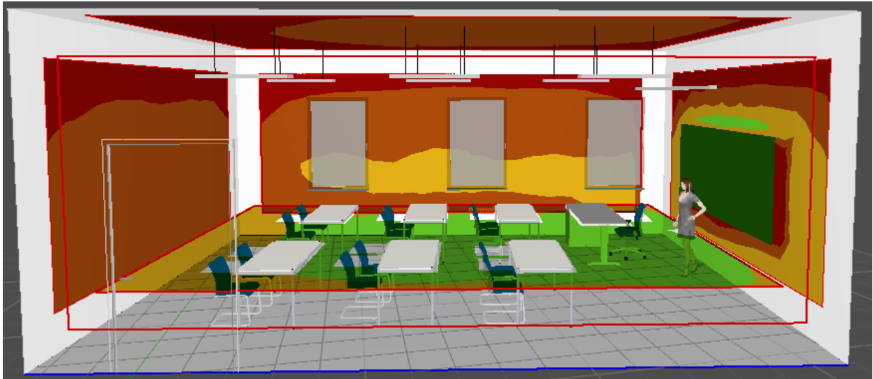
Slika 4.8. Prikaz izračunane raspodjele svjetla u 3D prostoru
