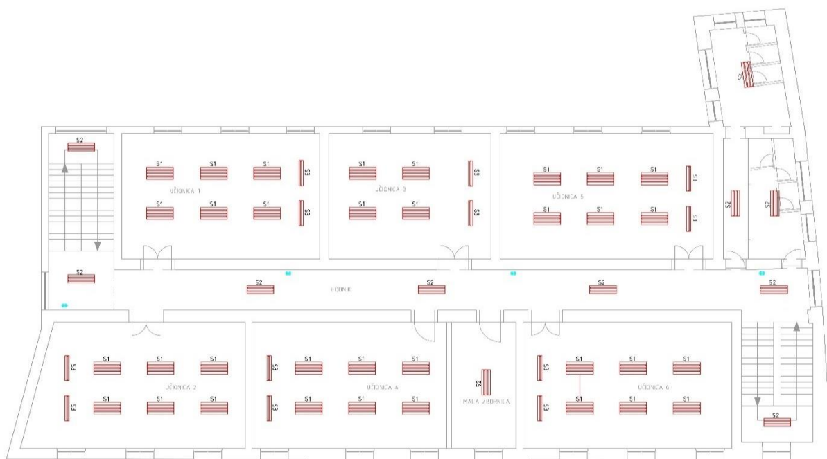
Slika 3.6. Tlocrt drugog kata – zatečeno stanje rasvjete
