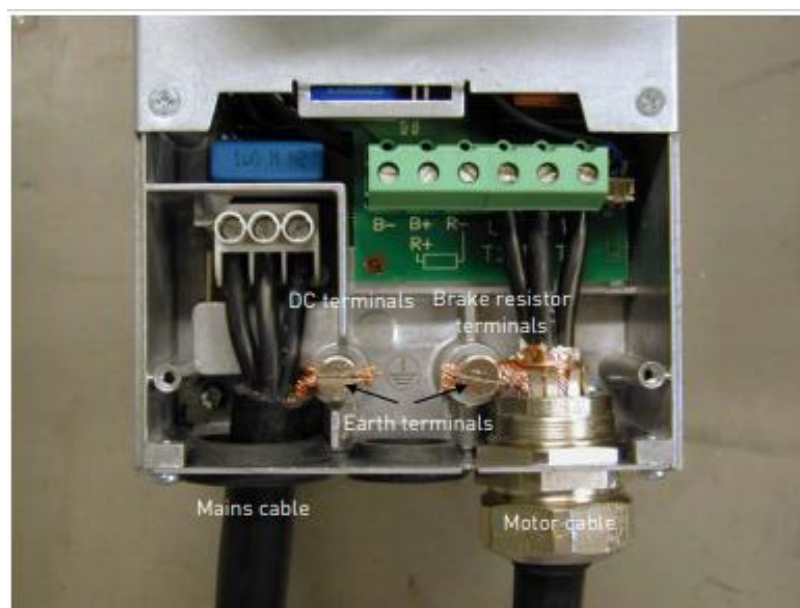
Slika 3.13. Ožičenje frekvencijskog pretvarača [14]
