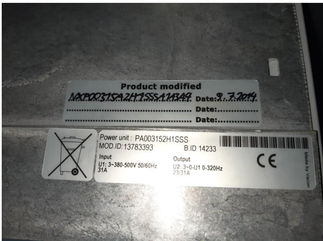
Slika 3.2. Natpisna pločica frekvencijskog pretvarača VACON NXP
