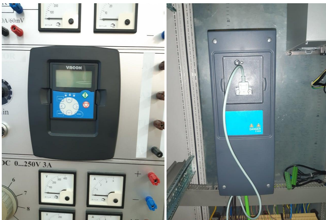
Slika 3.3. Frekvencijski pretvarač u učionici za laboratorijske vježbe
