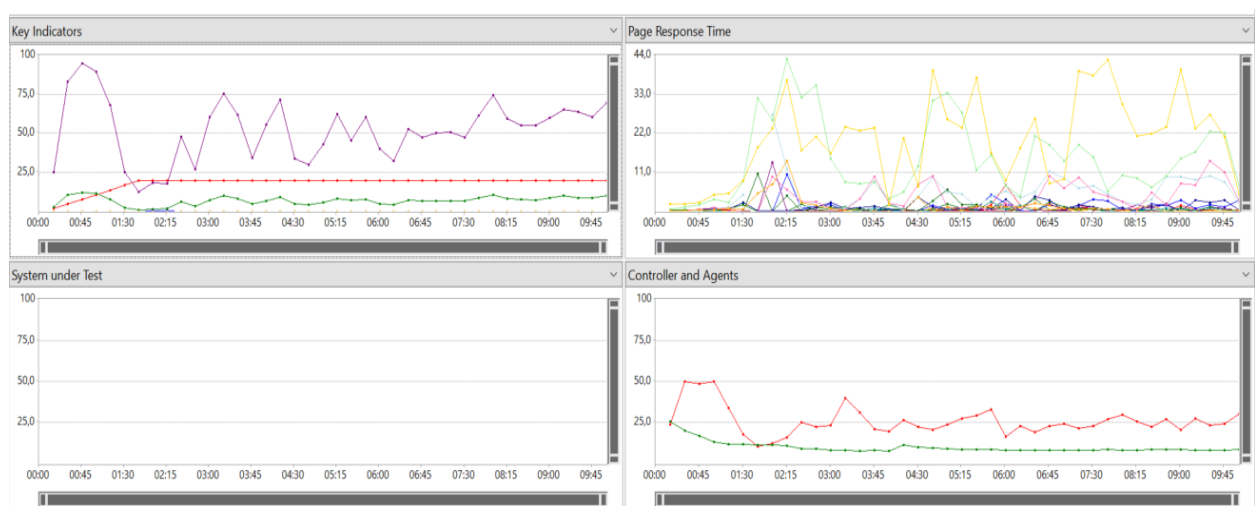
Slika 4.24. Grafički prikaz rezultata testa opterećenja iz alata VisualStudio [25]
