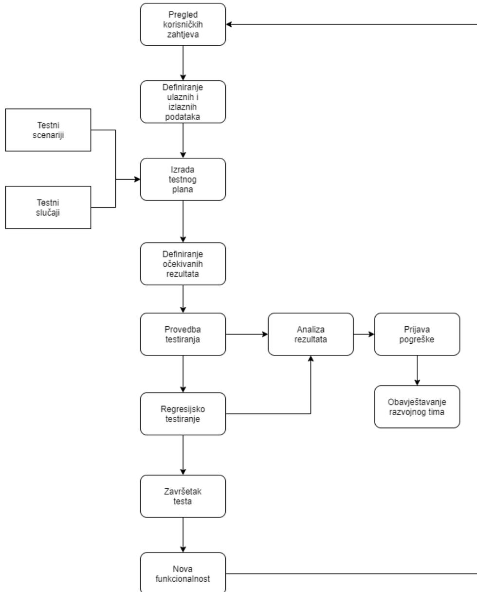
Sl. 2.1. Postupak provedbe funkcionalnog testiranja
