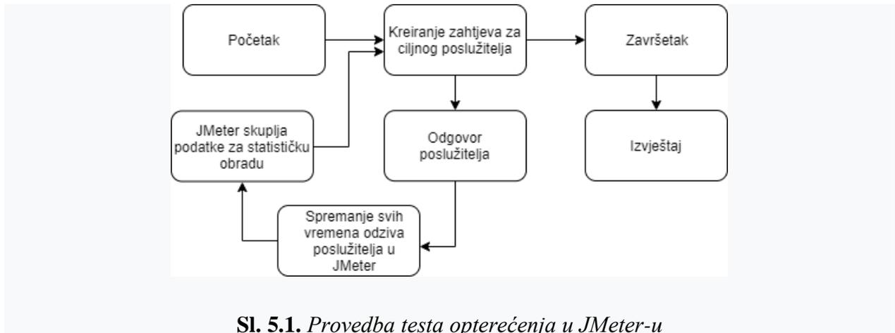
**Sl. 5.1.** *Provedba testa opterećenja u JMeter-u*
