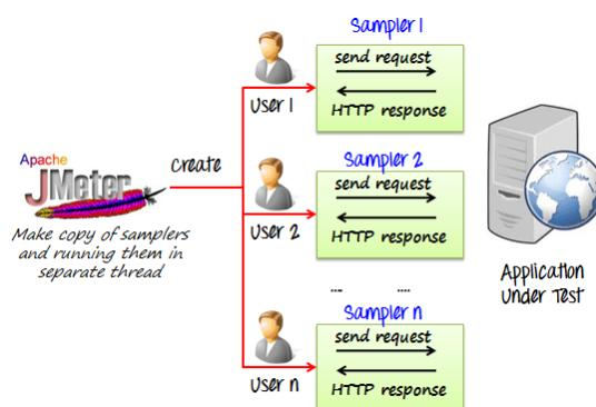
**Sl. 3.1.** Prikaz opterećenja sustava pomoću alata JMeter [22]
