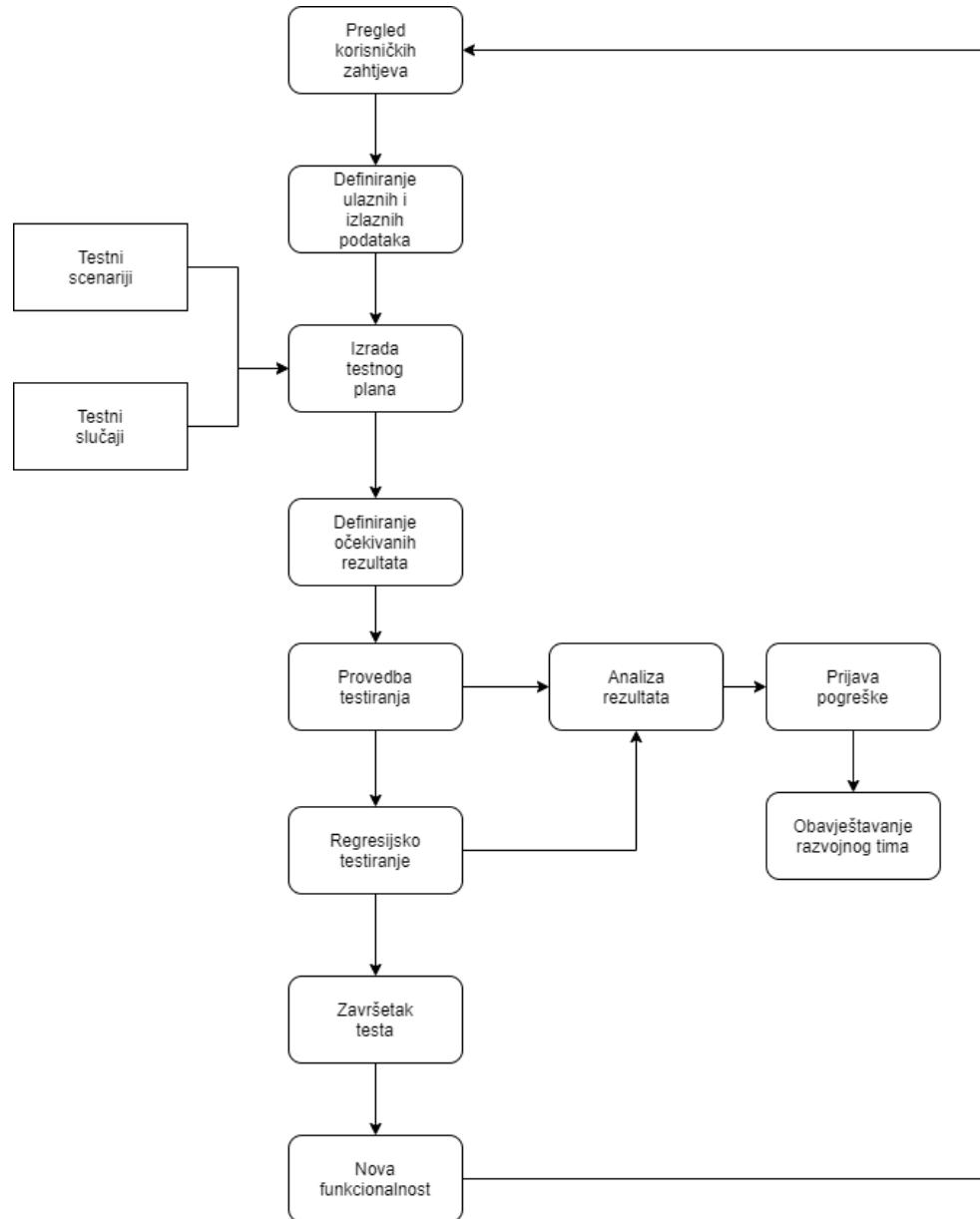
Sl. 2.1. Postupak provedbe funkcionalnog testiranja
