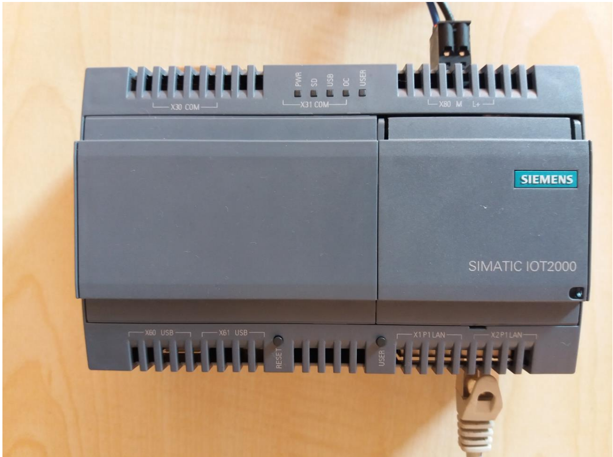
Slika 3.2 Siemens IOT2040 na kojemu je napravljen zadatak
