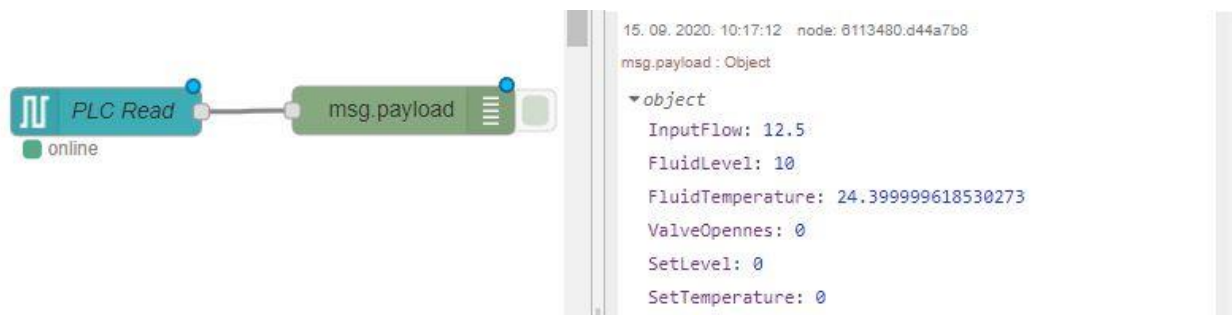
Slika 5.11 Izlaz bloka za dohvaćanje podata s PLC-a (objekt s imenom i vrijednostima varijabli)
