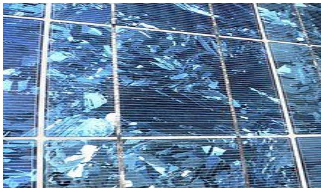
*Slika 3.9. Polikristalna fotonaponska celija*
