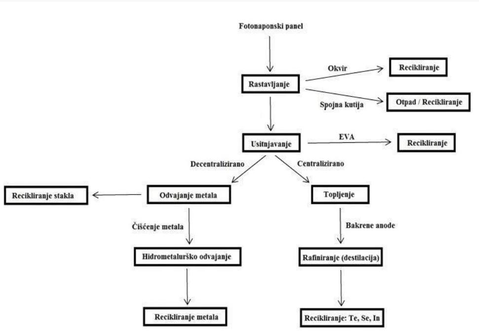
**Slika 4.4.** Shematski prikaz postupka recikliranja fotonaponskih panela [12]
