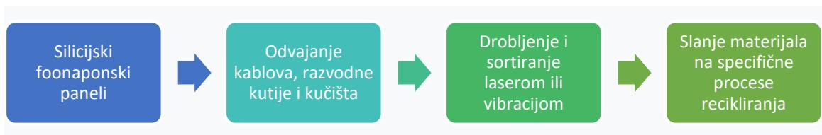
*Slika 4.2.* Tehnološki postupak recikliranja solarnih panela
