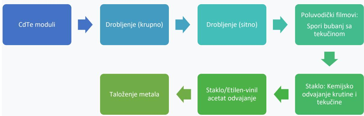
*Slika 4.3.* Tehnološki postupak recikliranja CdTe panela
