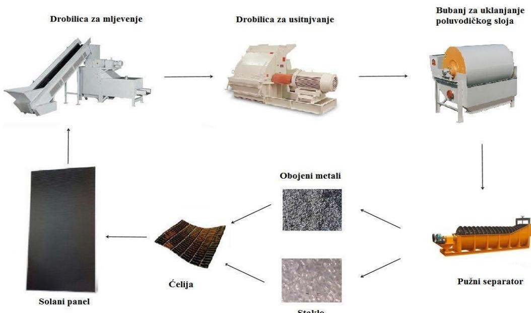
**Slika 4.9.** Proces recikliranja fotonaponskih panela na bazi kadmij telura [18]
