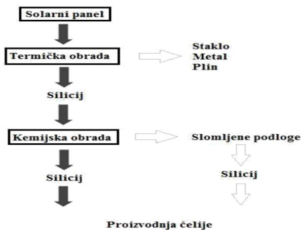
**Slika 4.7.** Tijek recikliranja fotonaponskih solarnih panela tvrtke *Deutsche Solar AG* [16]
