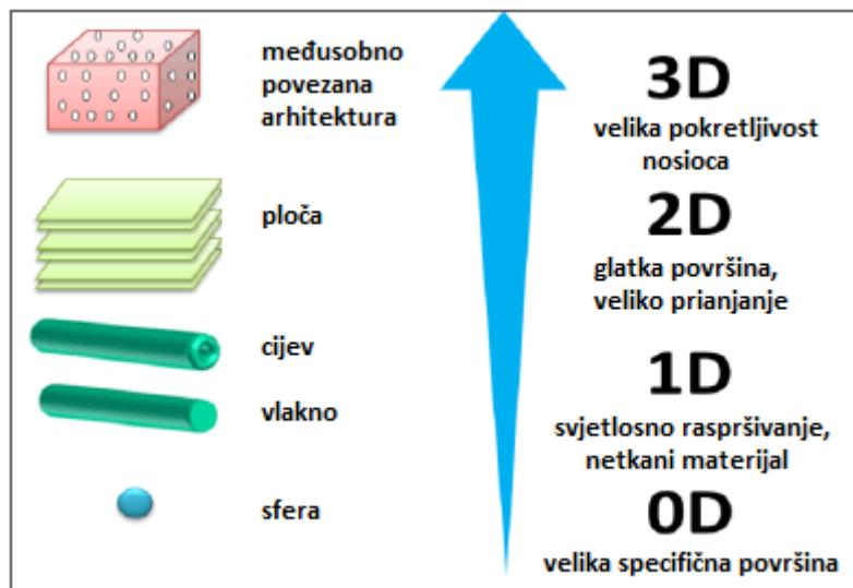
**Slika 3.1.** Shematski prikaz strukturne dimenzionalnosti nanomaterijala s očekivanim svojstvima [9]
