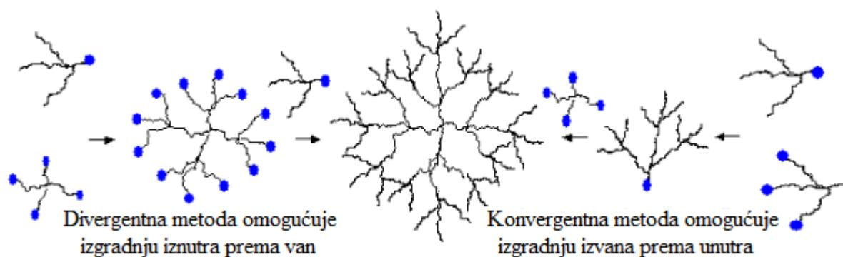
Slika 4.16. Divergentna i konvergentna metoda izgradnje dendrimera [24]
