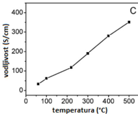
**Slika 4.3.** Ovisnost vodljivosti uzorka grafena o temperaturi [14]
