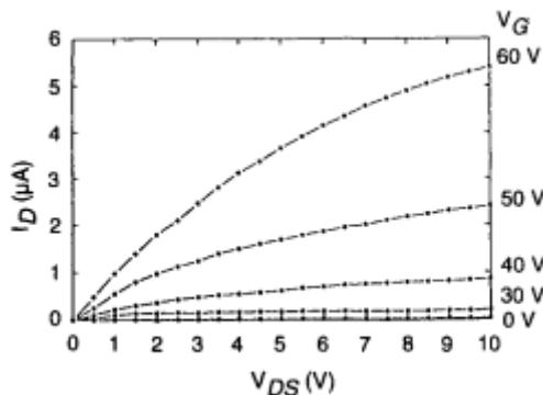
**Slika 4.8.** Strujno-naponska karakteristika n-tipa MOSFET-a na bazi fulerena , za različite napone upravljačke diode [20]
