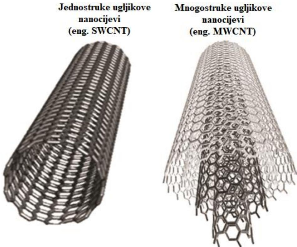
**Slika 4.10.** Podjela nanocijevi prema broju slojeva [21]
