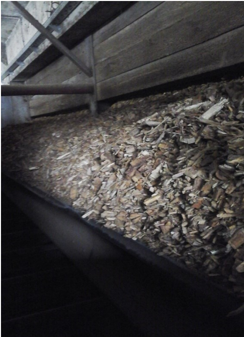
Slika 3.5. Sječka pada na traku
